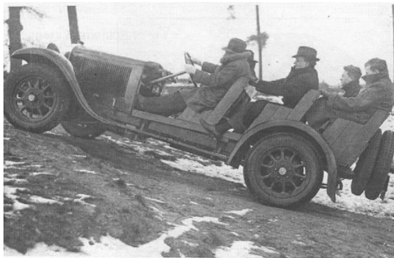
Abb. 17: Das Föttinger-Prinzip im PKW: Föttingers Versuchswagen Mercedes 8/35 (nach Leutz [20])
