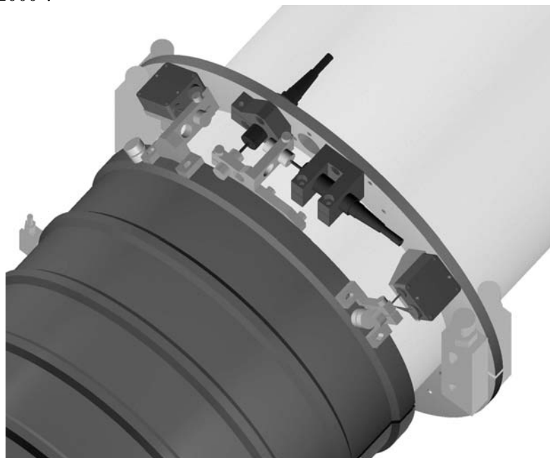
Abb.3: Moderne Messeinrichtung der Torsion von Schiffswellen, entwickelt am Institut für Schiffbau in Hamburg um 2000 5 .
