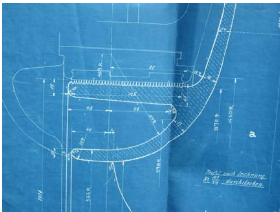
Bild 3 : Abdichtung des Laufrades gegen Leckwasser
