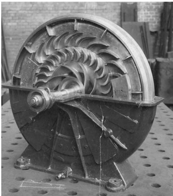
Bild 3 : Demonstrations-Modell eines einstufigenTransformators
